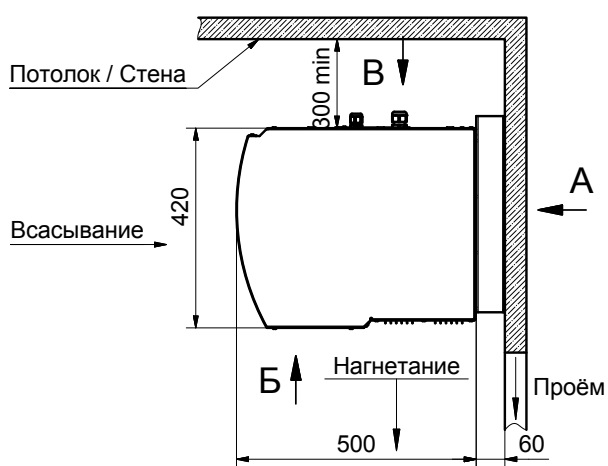
Рисунок 6. Габаритные и присоединительные размеры
